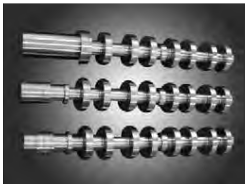
شکل ۱-۲ مراحل خشن کاری میل بادامک
