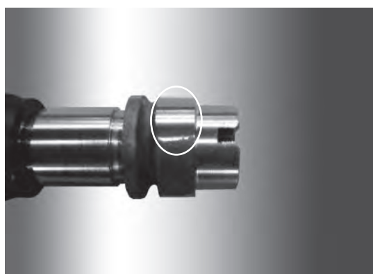
شکل ۸-۱۷ پرداخت‌کاری نهایی ناصحیح ناحیه یاتاقان‌ها (مردود)
