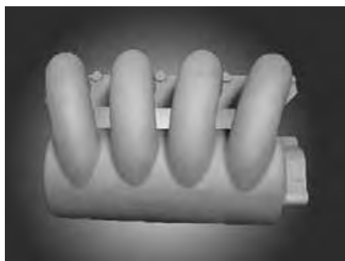
شکل ۱-۴ چند راهه هوا با مخزن آرامش پس از ریخته‌گری
