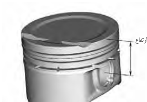
شکل ۵-۴ تعریف ارتفاع تراکم سمبه موتور ملی
