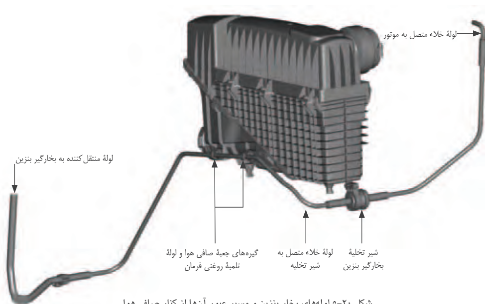
شکل ۲۰-۵ لوله‌های بخار بنزین و مسیر عبور آنها از کنار صافی هوا
