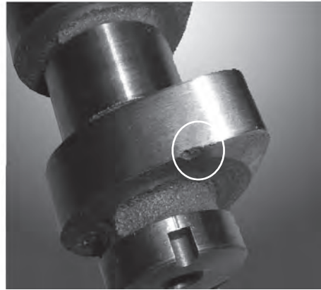
شکل ۸-۸ پرکردگی ضعیف ماده ریختگی در ناحیه ۱ و ۲ (مردود)
