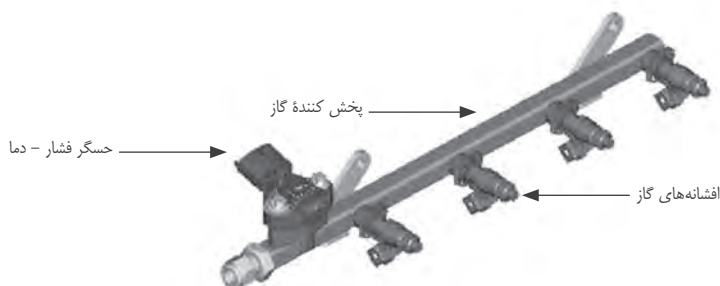
شکل ۸-۳ افشانه‌های گاز به طور مستقیم بر روی پخش‌کننده گاز نصب می‌شود.
