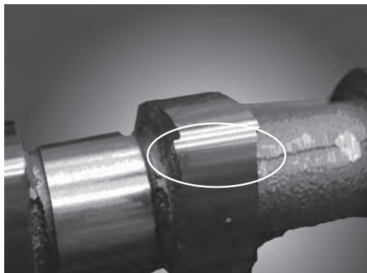
شکل ۸-۱۰ جابه جایی قالب (مردود)
