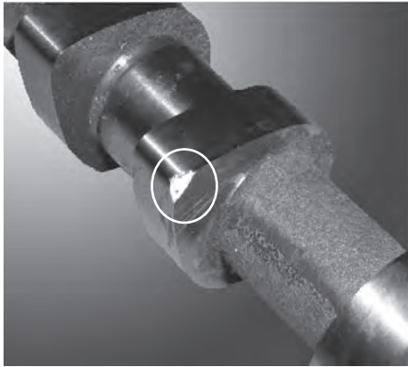
شکل ۸-۸ پرکردگی ضعیف ماده ریختگی در ناحیه ۱ و ۲ (مردود)
