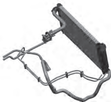
شکل ۶-۵ سامانه خنک‌کاری به همراه شلنگ‌های آب
