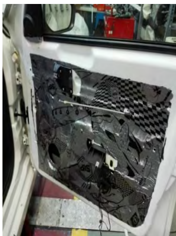
شکل ۷-۱۶ عایق کاری در خودرو
