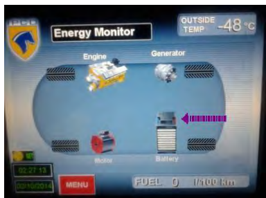
ذخیره‌سازی از طریق ذخیره‌ساز برق شهری شکل ۶-۴۳ چگونگی نمایش انتقال انرژی بین اجزای مختلف خودروی دو رگه در صفحه نمایشگر
