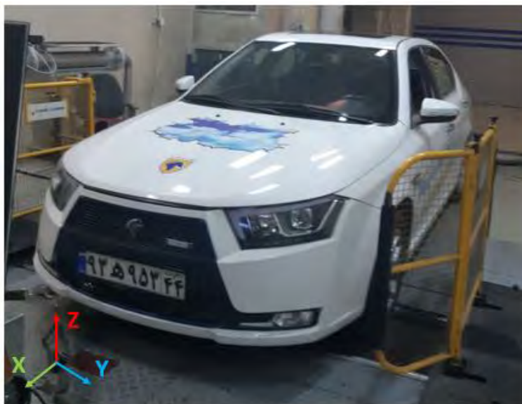
شکل ۸-۱ خودرو در اتاق آزمون خودرو بر روی لگام‌ترمز
