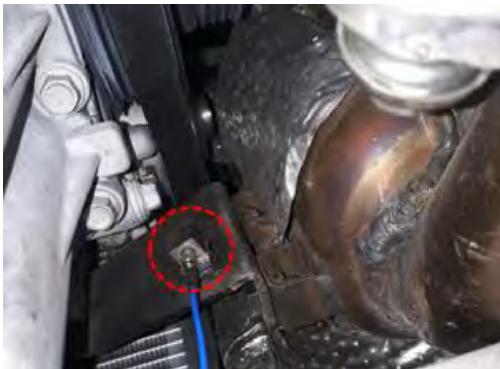
شکل ۸-۵ محل نصب شتاب‌سنج در مجاورت بازوی نگهدارنده واکنشگر
