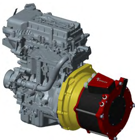
شکل ۴-۵ موقعیت قرارگیری قطعه واسط مبانی مولد برق و موتور احتراقی
