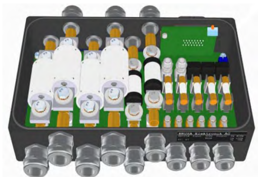
شکل ۶-۲۳ جعبه تقسیم مدار ولتاژ قوی خودروی دورگه
