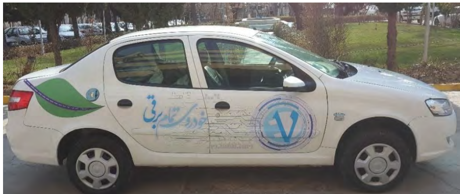
شکل ۱-۵ رانای برقی با قابلیت پیمایش ۲۰۰ کیلومتر با یک بار ذخیره سازی برق
