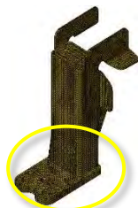
شکل ۳-۳۸ اجزای محدود نگهدارنده دسته‌موتور خودروی دورگه
