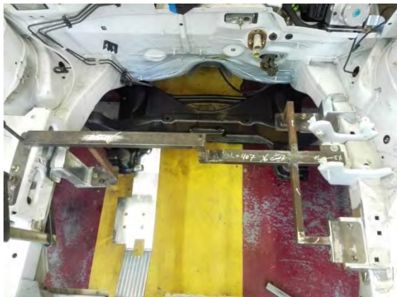
شکل ۶-۷ نصب موقعیت دنده بر روی بدنه
