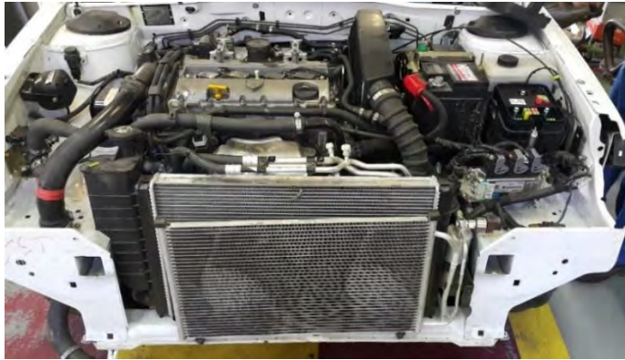
شکل ۱-۷ جدا کردن سپر خودرو، دیاق و سینی پروانه خودرو
