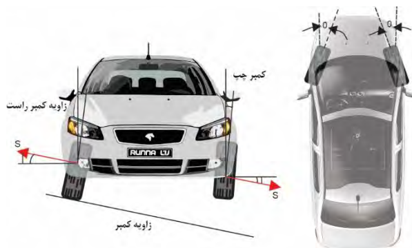
شکل ۱-۳ زوایای مهم در تحلیل سامانه تعلیق خودرو
