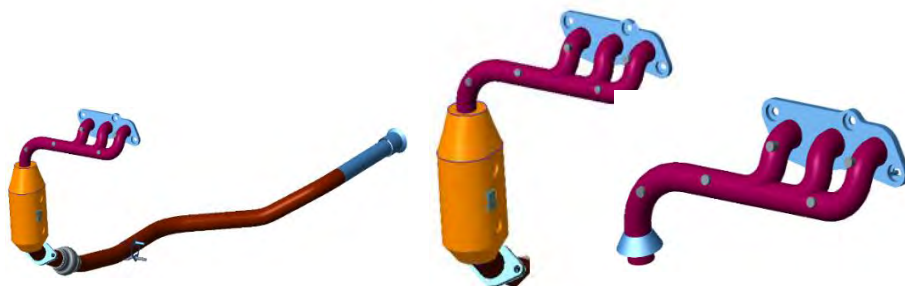
شکل ۱۷-۴ مجموعه چندراهه دود و پس پالایشگر موتور احتراقی
