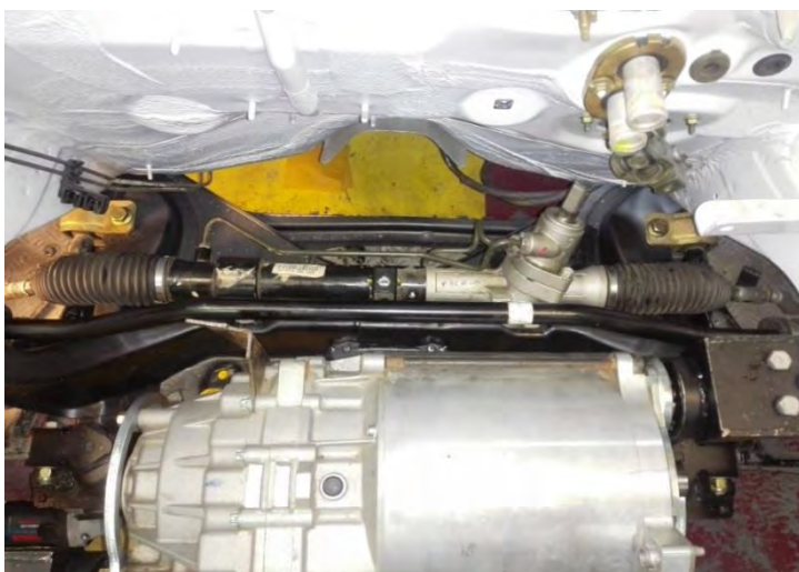
شکل ۷-۱۰ جانمایی مجموعه جعبه فرمان روی رام خودرو
