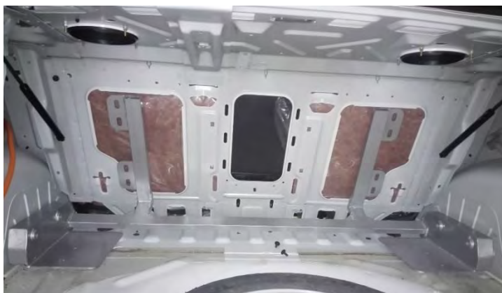
شکل ۷-۷ نصب نگهدارنده‌های انبارۀ برقی
