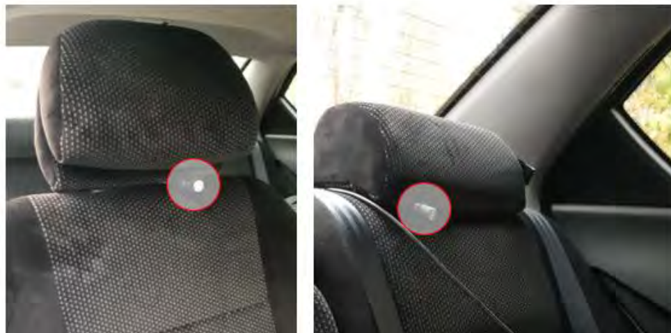
شکل ۸-۳ محل نصب حسگرهای صدا داخل خودرو
