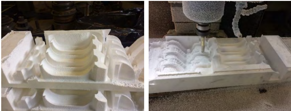
شکل ۱-۹ ماشینکاری قالب کفسانی چندراهه هوای موتور احتراقی
