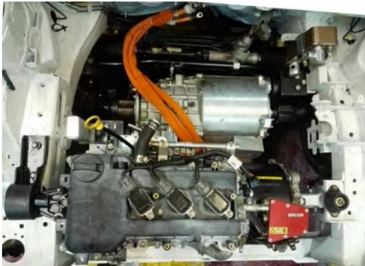
شکل ۷-۱۱ سوار کردن موتور احتراقی به همراه دسته‌موتورهای راست و چپ
