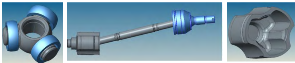
شکل ۴-۲۷ لاله‌گی، موقعیت قرارگیری لاله‌گی نسبت به محور انتقال قدرت و سه‌شاخه
