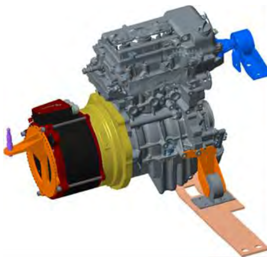
شکل ۴-۱۳ موقعیت قرارگیری دسته‌موتور زیرین موتور احتراقی
