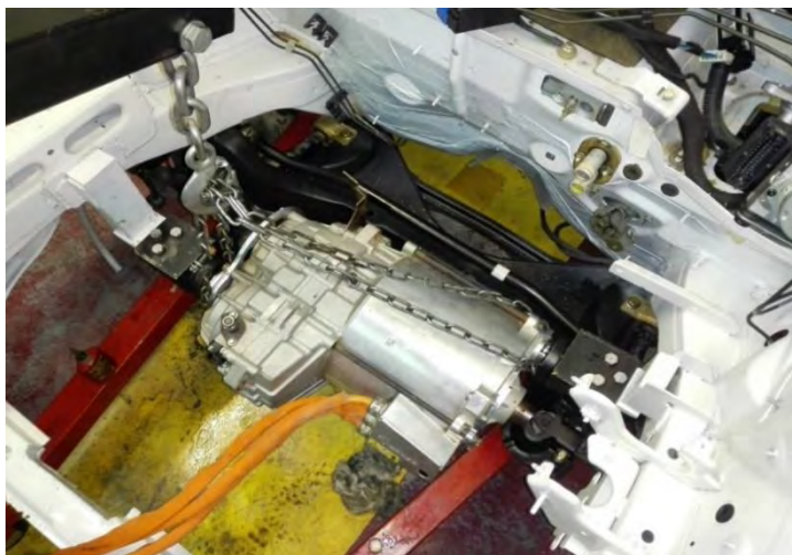
شکل ۷-۸ نصب موتور برقی بر روی بدنه
