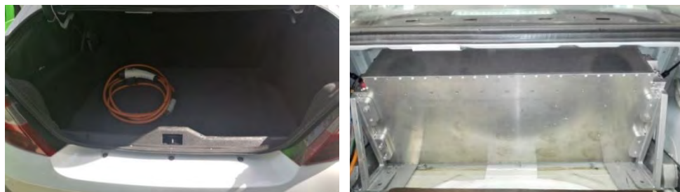
شکل ۷-۱۴ جانمایی انبارهٔ برقی در صندوق عقب
