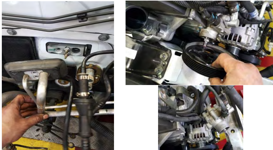
شکل ۳-۷ جدا کردن سامانه تلمبه روغنی فرمان و تهویه مطبوع
