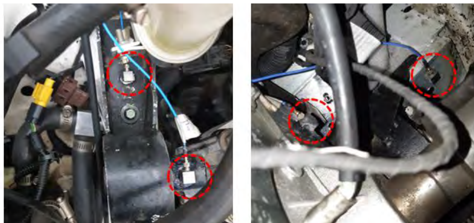
شکل ۸-۹ محل نصب حسگرها روی دسته‌موتور چپ موتور برقی (سمت راست) و دسته‌موتور راست موتور احتراقی (سمت چپ)
