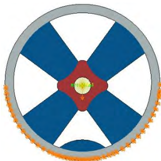
شکل ۳-۳ قیدهای مکانیکی اعمال شده به دسته‌موتور
