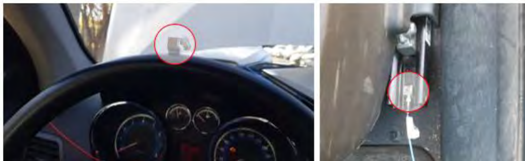
شکل ۸-۲ محل نصب حسگرهای شتاب‌سنج داخل خودرو
