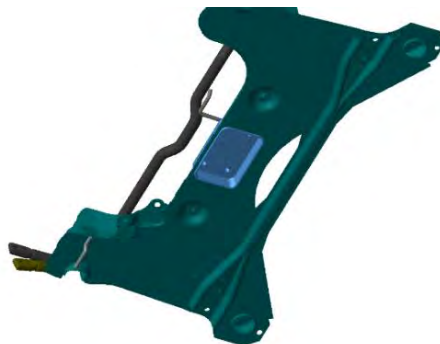
شکل ۴-۹ جوشکاری قطعه مکعبی به رام
