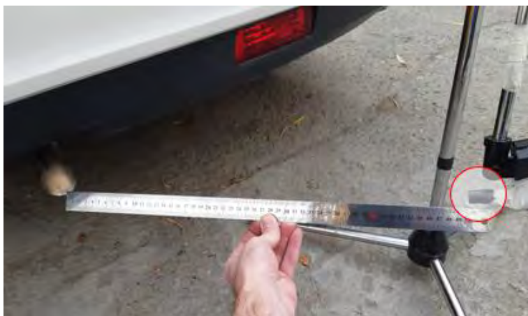
شکل ۸-۱۱ محل نصب حسگر صدا مقابل لوله خروج دود
