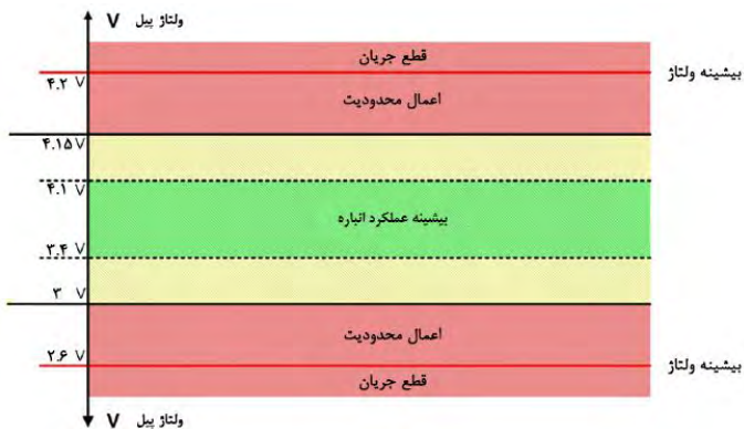
شکل ۵-۶ نحوه اعمال محدودیت در جریان و ولتاژ سلول‌های مختلف
