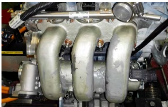
شکل ۷-۱۲ چندراهه‌های جدید دود و هوا در موتور سه‌استوانه
