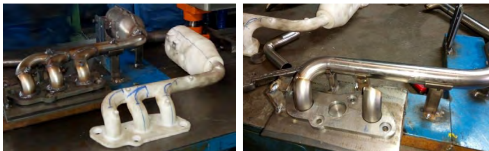
شکل ۹-۳ چندراهه دود و روش ساخت نمونه
