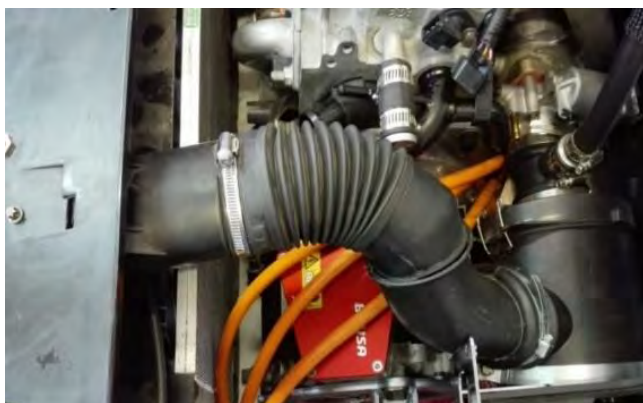
شکل ۷-۱۳ نصب صافی هوا و لوله‌های مسیر بخار روغن
