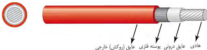
شکل ۶-۲۷ اجزای تشکیل دهنده بافه جدول ۶-۱۶ مشخصات بافه استفاده شده در خودروی دورگه
