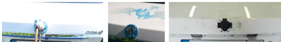
شکل ۷-۱۷ برشکاری بدنه خودرو برای تعبیه محل اتصال برق شهری به انباره برقی
