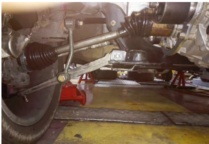
شکل ۷-۹ نصب محورهای محرک چپ و راست خودرو
