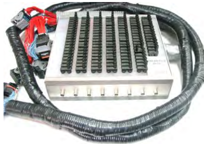
شکل ۶-۱۰۰-۱ مبدل واسط رایانه موتور برای عیب‌یابی
