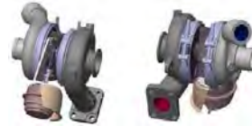
شکل ۲-۱۹- گونه‌های مختلف پرخوران برای آزمون‌های احتراقی موتور دیزل سواری
