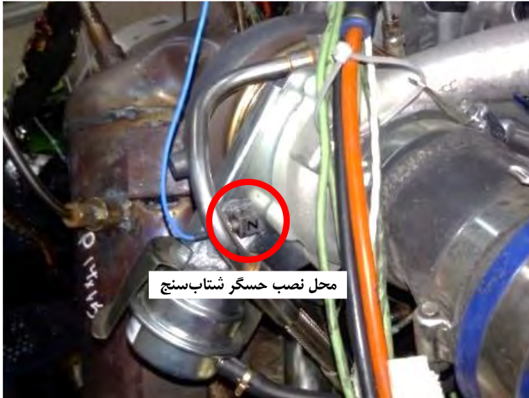
شکل ۳-۳۸- نقاط نصب حسگرهای شتابسنج در آزمون ارتعاشی
