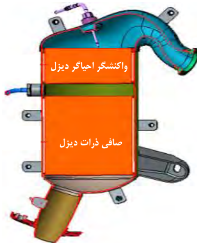
شکل ۴-۱۶۵- سفالینه واکنشگر موتور دیزل
