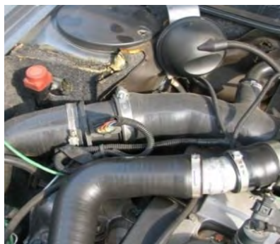
شکل ۶-۹- نماهایی از نصب حسگر صفحه داغ بر روی خودرو
