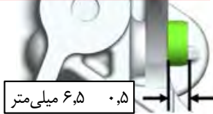
شکل ۱۲-۴۳- نحوه بستن دسته موتور عقبی با ۴ عدد پیچ
