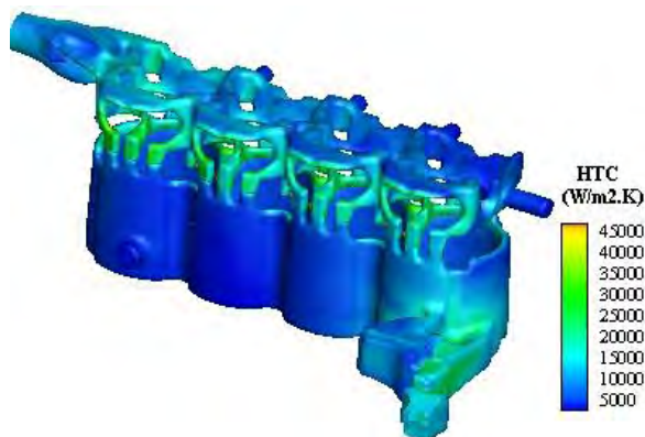
شکل ۳-۹- ضریب انتقال گرما روی سطح داخلی راهگاه آب
