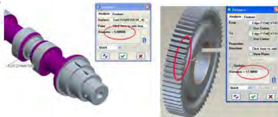
شکل ۴-۸۸- محاسبه نیروی فشاری بین میل بادامک و چرخ‌دنده میل بادامک
