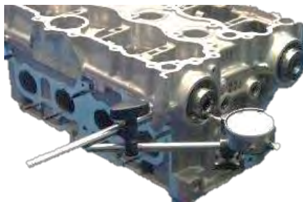
شکل ۱۲-۷- اندازه‌گیری لقی محوری میل‌بادامک
