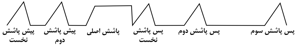
شکل ۴-۱۴۱- چگونگی زمان بندی پاشش سوخت
