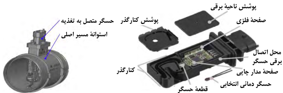
شکل ۶-۷- نمای کلی از حسگر صفحه داغ
