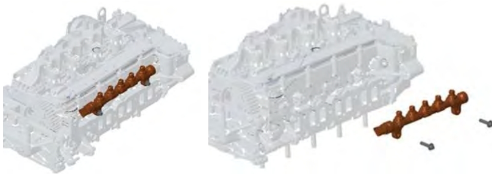
شکل ۴-۱۴۴- چگونگی قرارگیری چندراهه در بستار
