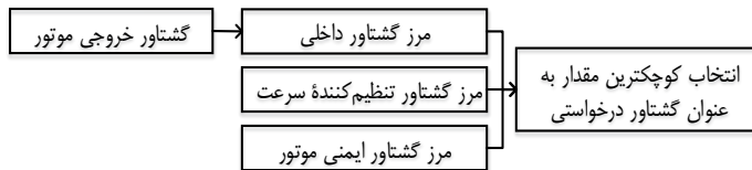
شکل ۶-۷۹- روندنمای انتخاب کوچکترین مقدار به عنوان گشتاور درخواستی
