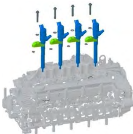
شکل ۴-۱۴۰- چگونگی بستن افشانه‌ها روی بستار
