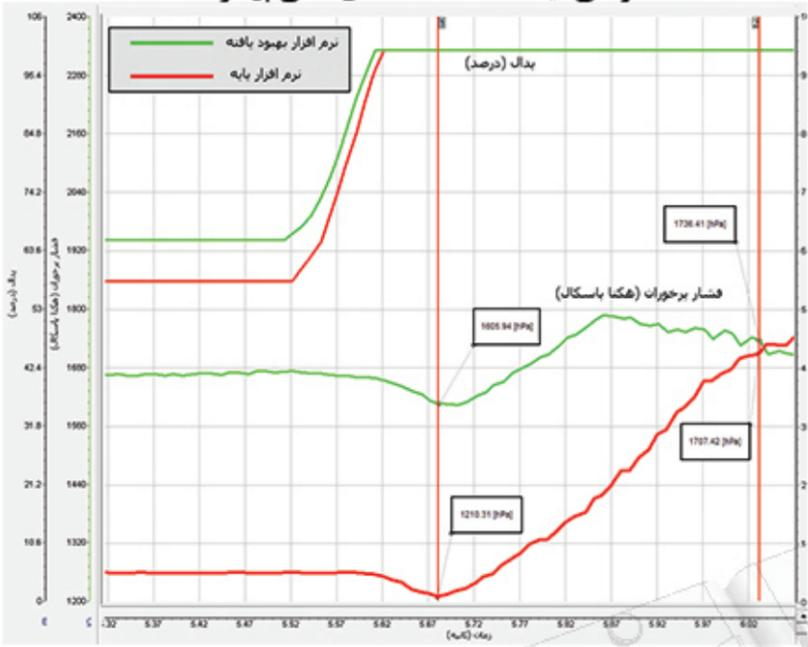
کاهش دمای روشن شدن پروانه، کاهش دمای باز شدن دمايان و کاهش محدودیت‌های احتراقی کوبشی با هدف افزایش گشتاور بیشینه موتور
